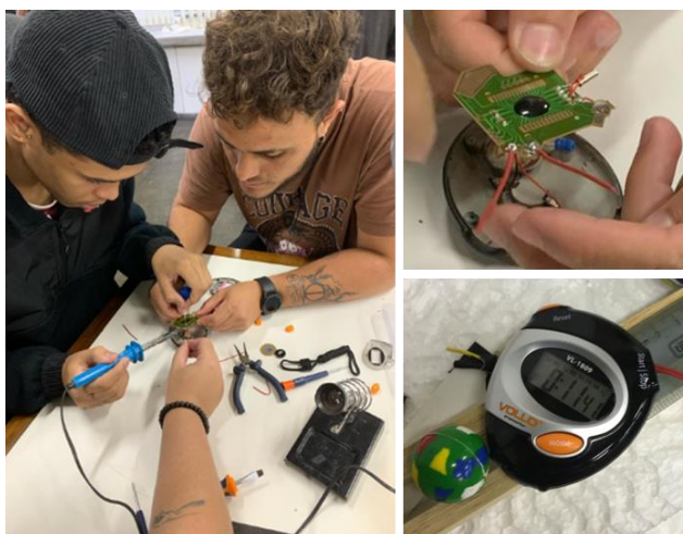
Figura 1 - Pibidianos Felipe e Vinícius soldando a chave magnética no cronômetro (foto maior). Na foto do canto superior direito da imagem, a placa exposta com os fios soldados. Imagem no canto inferior esquerdo: foto do cronômetro após a remontagem.
